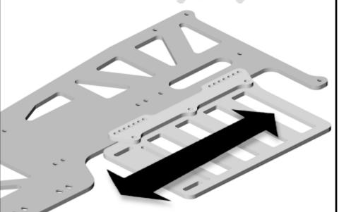
SHIFT BATTERY WEIGHT FRONT TO BACK SLIDE YOUR BATTERIES INWARD AND OUT
