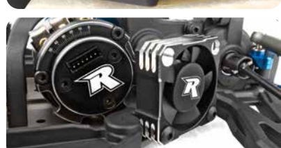
Updated fan mounts and fan location
